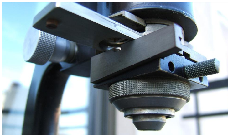
Figure 27. La plaquette coulissante au-dessus de l'objectif permet d'interposer l'analyseur sur le parcours du faisceau lumineux.
