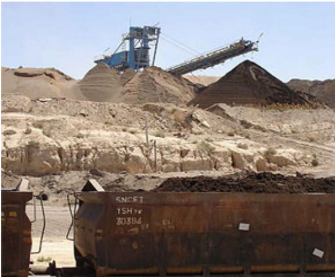
Figure 19. Bandes transporteuses et les wagons d'évacuation du minerai.
