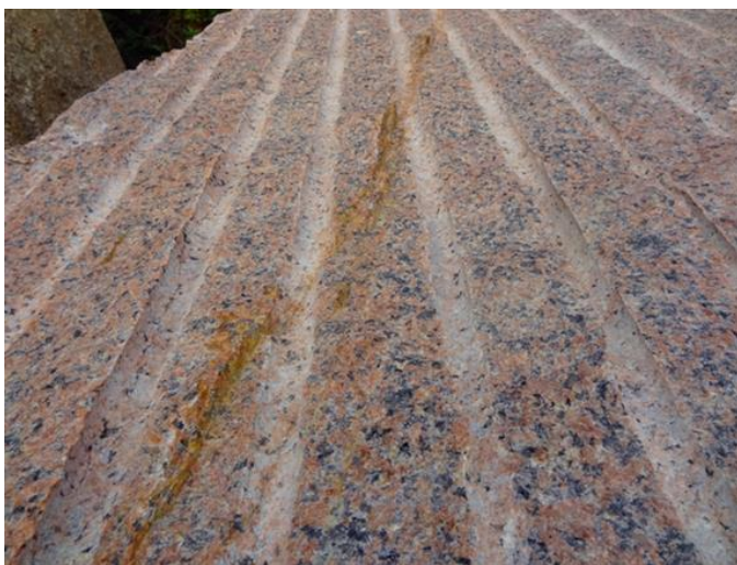
Figure 13. Diaclase pénétrée par l'eau avec libération du fer des biotites altérées.
