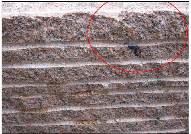
Figure 14. Présence d'un « crapaud » de biotite sur une face d'un bloc commercialisable (risque de rebut). (Photo H. Pouchelle).
