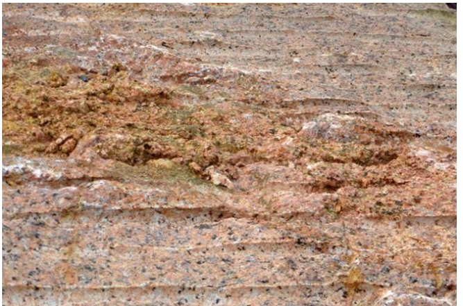
Figure 15. Altération hydrothermale des plagioclases (saussurisation) et décohésion du granite : « granite pourri ». (Photo J.-L. Fromont).
