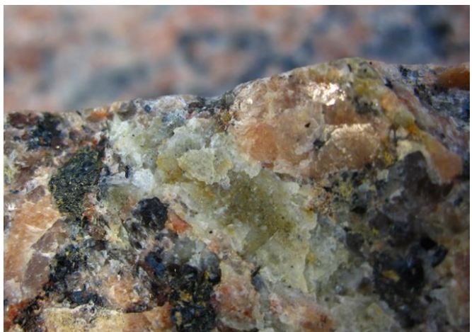
Figure 16. Macrophotographie d'un plagioclase en phase avancée de saussurisation. (Photo H. Pouchelle).
