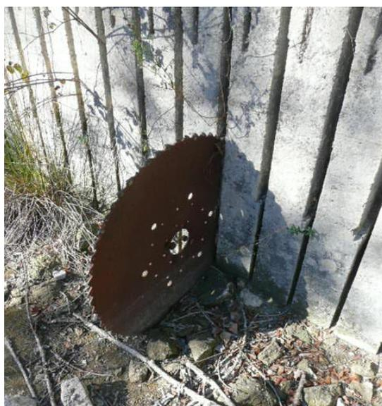
Figure 5. Lame d'une ancienne scie circulaire à lame unique ne permettant que des traits verticaux. Les blocs devaient ensuite être détachés de la base avec coins et masse.
