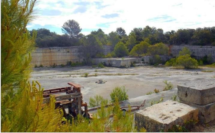
Figure 7. Plateau d'extraction d'une carrière plus récente (années 60). Au premier plan, une machine à lames horizontales et verticales multiples permettant de produire directement des moellons terminés.
