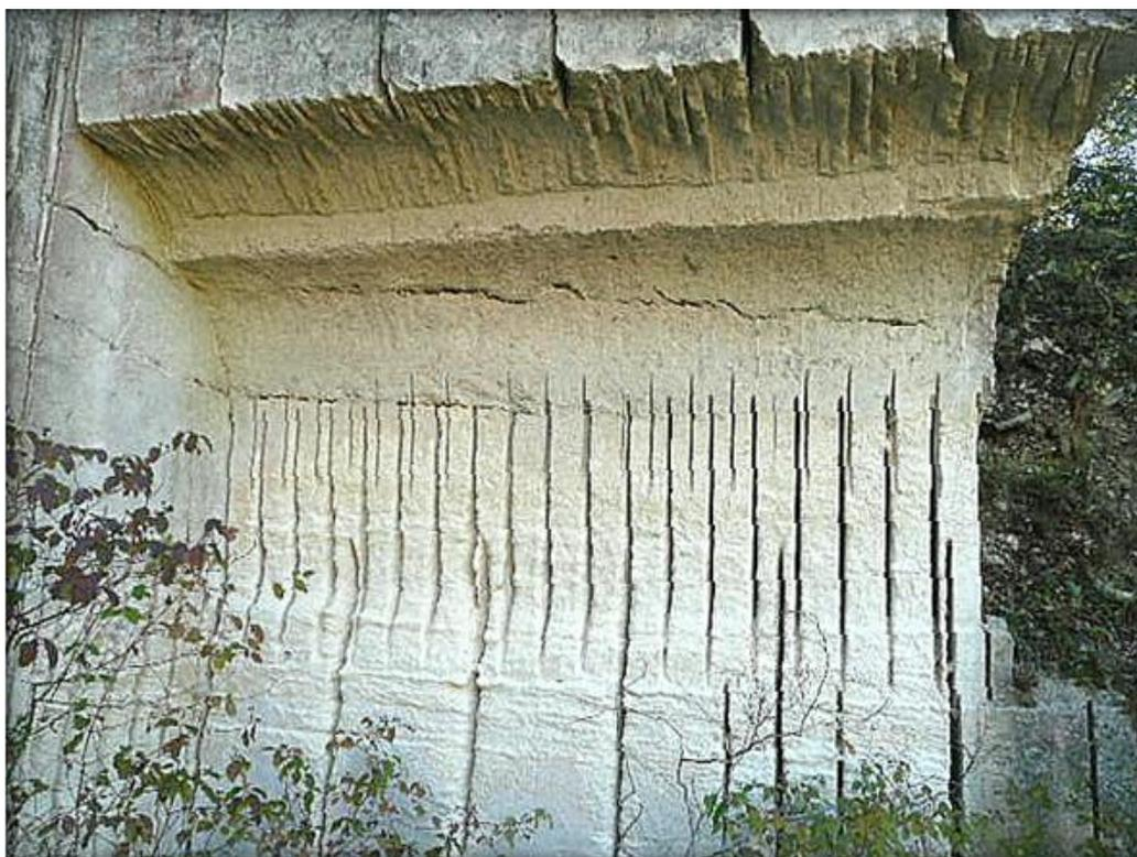
Figure 1- Un aspect remarquable du front de taille d'une ancienne carrière de Reganhat, à Saint-Geniès-des-Mourgues, avec des traces de découpe « artistiques » de scie circulaire (photo M. Gastou).
