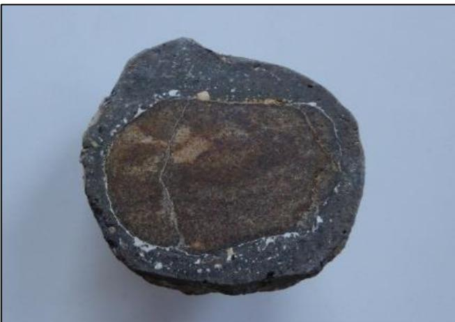
Figure 22. Coupe par sciage d'un lapilli de carbonatite. Diamètre 6 cm. (Cliché D. Rossier).
