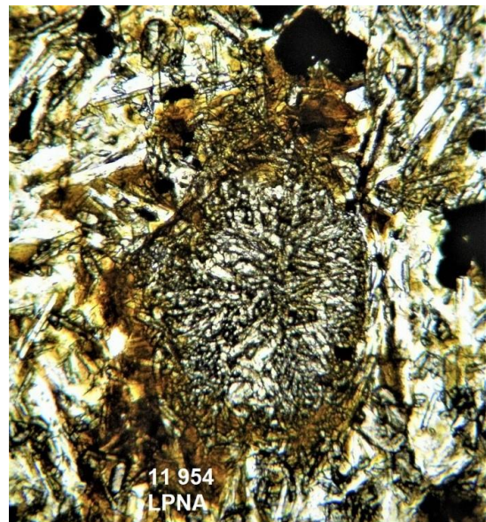
Figure 13. Lame 11 954, prélèvement sur le cône strombolien tronqué de la Franconèche. Cliché LPNA. Cumulat composé de centaines de microlites d'augite, au sein d'une mésostase microcristallisée (plagioclases, olivine et clinopyroxène, magnétite, néphéline). Échelle : 2 mm à la base. Cliché D. Rossier.
