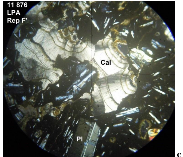
Figure 10c. Couronne multiple de sphérolites, à extinction en croix de Malte, en remplissage d'une vésicule de la roche. LPA, échelle : 3 mm à la base. Cliché D. Rossier.
