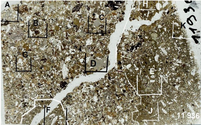
Figure 13. Scan en lumière polarisée non analysée de la lame 11 936. Les contours en ligne blanche isolent les fragments laviques de composition trachyandésitique. Échelle : 3,5 cm à la base. Cliché D. Rossier.
