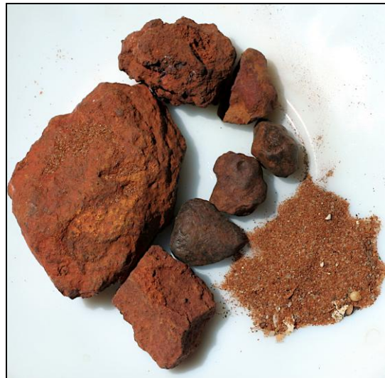
Figure 5, à gauche. Chemin latéritique à Assinie, Côte d'Ivoire, 2003. Photo J.-M. Labouille. Figure 6, à droite. Latérite, sable et nodules ferrugineux typiques de la zone tachetée nodulaire (carapace). Assinie, Côte d'Ivoire, 2003. Photo J.-M. Labouille.
